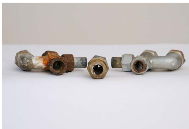
DOORSTROMING EN BETROUWBAARHEID IS VER TE ZOEKEN BIJ DOOR DIFFUSIE AANGETASTE KOPPELINGEN.
